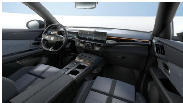
Intelli sedadlá, ergonomické AGR komfortné sedadlá, čalúnenie Bird/PVC, čiernosivé z recyklovaných materiálov, vyhrievané predné sedadlá (CDFT)
